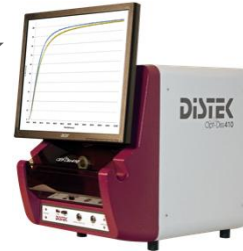
Fiber-Optic-UV „DISTEK Opt-Diss“ für Echtzeit- Messung und Alternative für teure HPLC- Analysen
