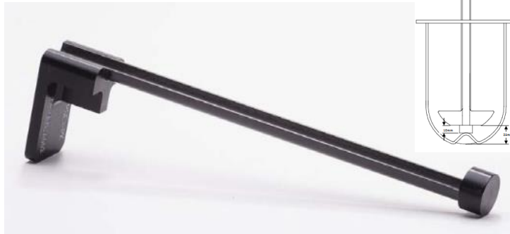
Depth Set Tool für Peak Vessels, um die 10 bzw. 25mm genau einzustellen
